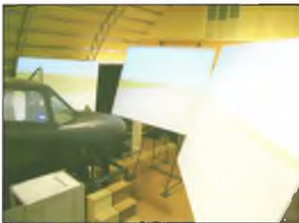
Рис.17.6. Трехканальная проекционная система имитации визуальной обстановки
