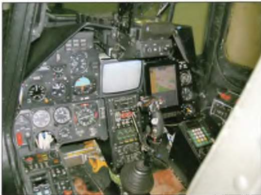
Рис.17.3. Приборы и оборудование рабочего места летчика тренажера "Краб"
