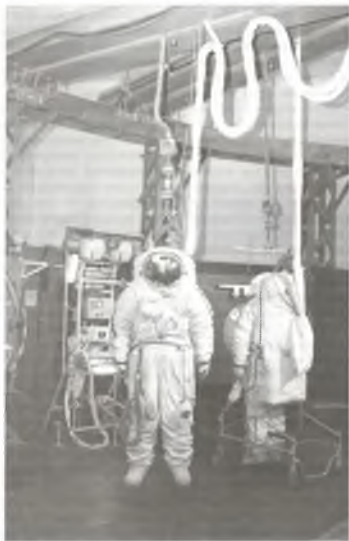
Рис. 11.12. Общий вид системы обезвешивания скафандров "Орлан-ДМА"
