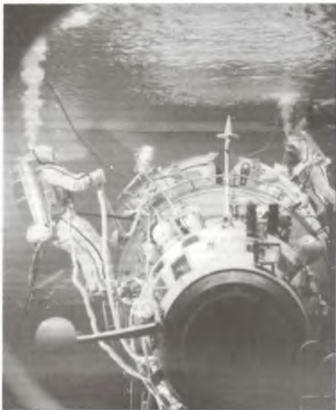
Рис. 11.10. Фрагмент работы космонавтов в гидросреде в скафандрах "Орлан-ДМА-ГН"
