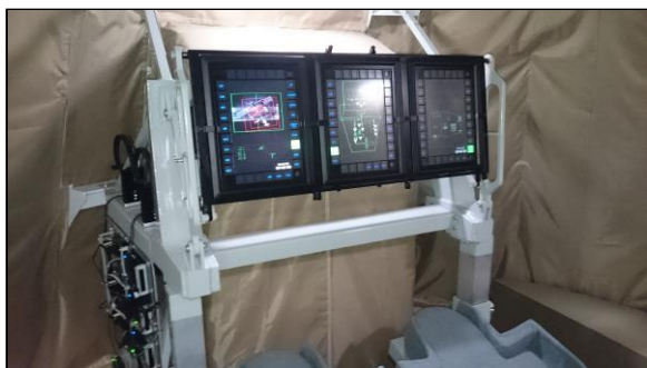
Рис. 3. Интерьер макета КО ПТК и конструктив пульта космонавтов
