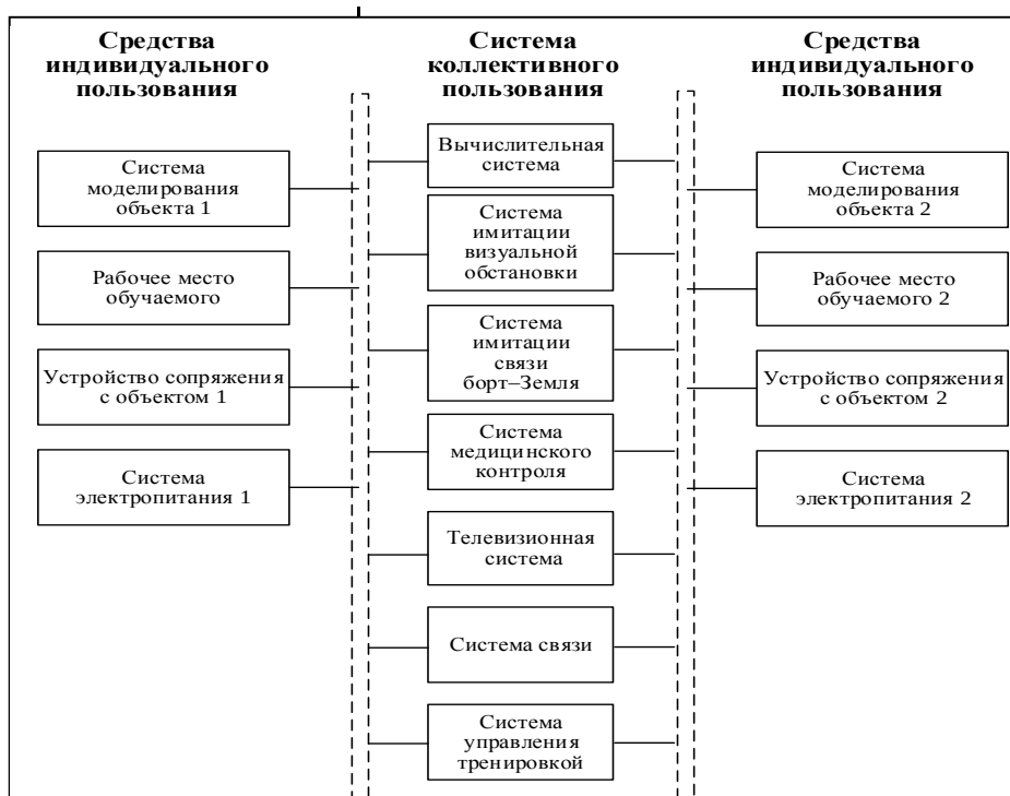
Рис. 2. Типовой состав подсистем индивидуального и коллективного пользования космического тренажера
