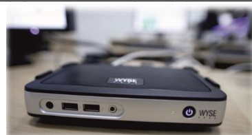
Тонкий клиент Dell Wyse P25 (управление и контроль форматов)
