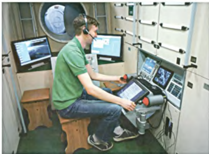
Рисунок 5.15 – Выполнение ручной стыковки грузового транспортного корабля «Прогресс» с Международной космической станцией в телеоператорном режиме
