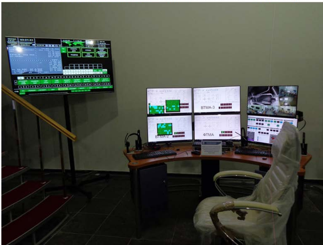
Фото 4 – Пульт контроля и управления экипажами виртуального и физического аналогов транспортного космического корабля «Союз-ТМА» (автоматизированное рабочее место инструктора тренажеров транспортного космического корабля «Союз-ТМА») г. Киров «Детский космический центр» каб. 104 6 декабря 2016 г.
