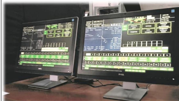
Интегрированный тонкий клиент в конструктиве монитора рабочего места обучаемого в ФМС, виртуального тренажера или элемента ПКУ
