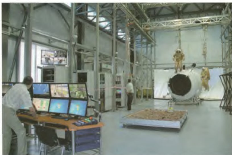
Многофункциональная трёхкоординатная система для подготовки космонавтов к внекорабельной деятельности в открытом космосе, на планетах «Луна» и «Марс» и на астероидах
