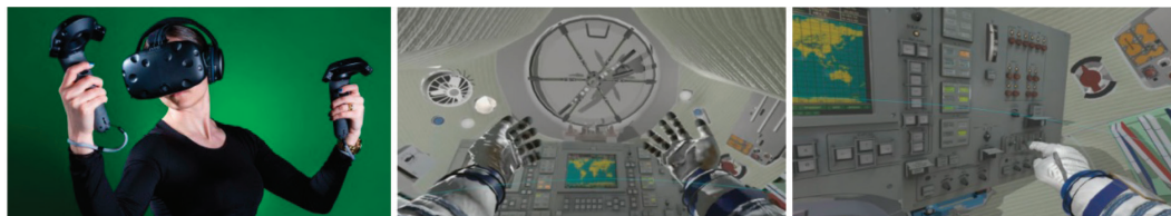
Рис. 1. Шлем HTC Vive с датчиками захвата движений рук и виртуальные образы шлема HTC Vive при работе внутри СА и управлении оборудованием
