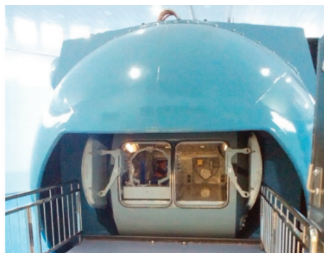
Рис. 2. Общий вид двухместной кабины со стороны входа. Люки открыты. В левом отсеке размещается врач УЗДГ, в правом – испытуемый (космонавт)
